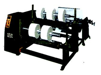
HIGH SPEED PAPER AND BOARD SLITTER/REWINDER
